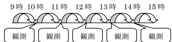
図3 Hourly JNoVA0の模式図。矢印はNHMの予報を表す。毎時、NHMの1時間予報値を第一推定値としてJNoVA0により観測データを同化する。
